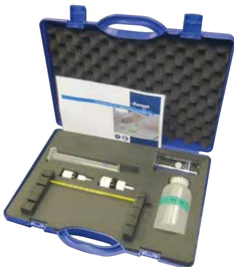
Un kit complet pour mesurer la concentration de détergent dans le bain de nettoyage. Ce kit est livré dans un coffret en plastique. Un mode d'emploi clair vous guide pas à pas dans le processus de titrage. Ce kit permet de faire environ 50 titrages.
