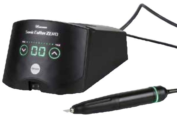
Le NSK Sonic Cutter ZERO est un appareil de coupe de haute qualité. Grâce aux vibrations ultrasonores, il atteint une vitesse de 38 000 à 40 000 mouvements par seconde. Ceci est idéal pour couper, cisailler ou ébavurer, par exemple, du tissu, du latex, des films, des plastiques, des polyuréthane ou d'autres matériaux fins. Les motifs de PCB peuvent également être retouchés avec.
