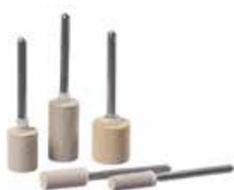
Meules sur tige en fibres de coton non tissées, imprégnées d'oxyde d'aluminium, avec un liant résine.
