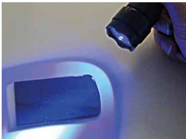
Lampe torche LED ultraviolet compacte. Pour la détection rapide et efficace de particules sur les surfaces, qui ne sont pas visibles à la lumière normale.
